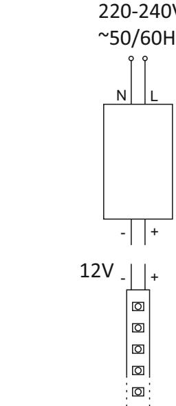
utilizare, asigurați-vă că o conexiune buna de montare mecanice și electrice. Nu se permite conectarea benzilor LED în secțiuni mai lungi de 5 m. Aplicațiile care necesită utilizarea unor lungimi mai mari ar trebui să fie separate electric (conectate în paralel), pe porțiuni cu o lungime de până la 5m.
